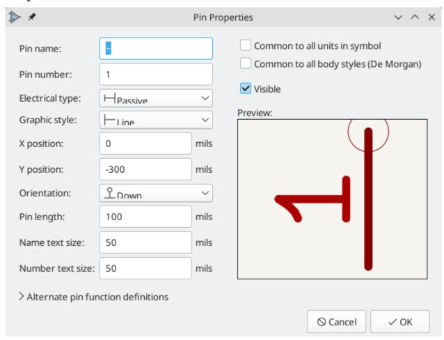
Kotak dialog properti pin digunakan untuk mengedit karakteristik dari sebuah pin. Kotak dialog ini akan muncul secara otomatis ketika Anda membuat sebuah pin atau melakukan klik-ganda pada pin yang sudah ada. Kotak dialog ini dapat digunakan untuk mengubah:
